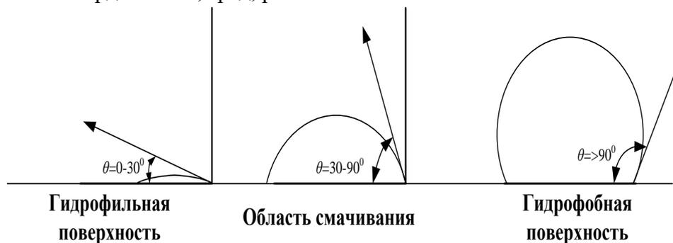
Рис. 1. Угол смачивания на различных поверхностях
