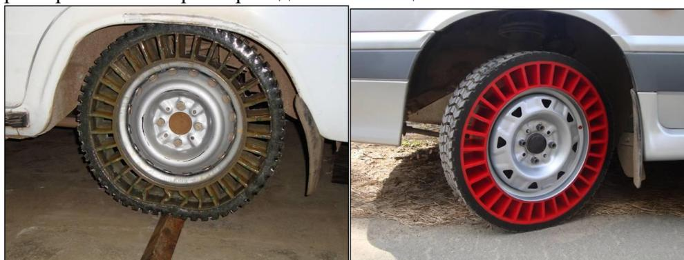
Рис. 3. Автомобильные колёса с безвоздушными шинами
