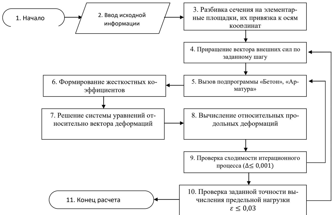
Рис. 2. Блок-схема программы расчета внецентренно сжатых железобетонных элементов по нелинейно-деформационной модели
