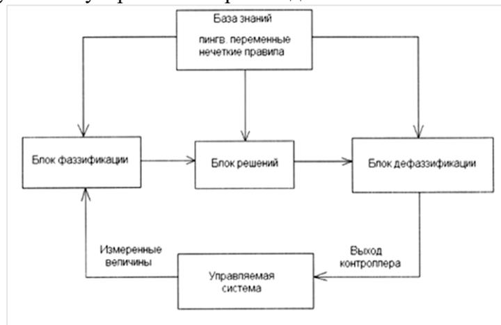
Рис. 2. Структура контроллера нечеткой логики
