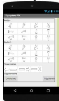
Рис. 4. Приложение на устройстве Android для удалённого управления РТК
