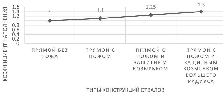
Рис.5. График зависимости коэффициента наполнения от конструкции отвалов.
