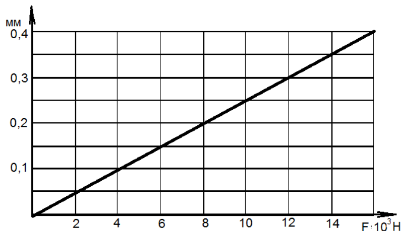
Рис. 2 Тарировочный график динамометрического кольца
