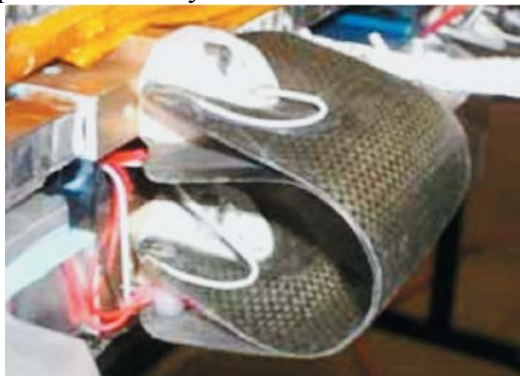
Рис. 3. Самораскрывающаяся петля из композита с памятью формы
