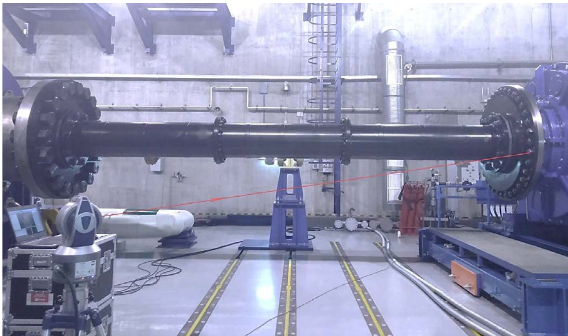
Рис. 4. Использование лазерного трекера в производстве (контроль размеров трансмиссии)
