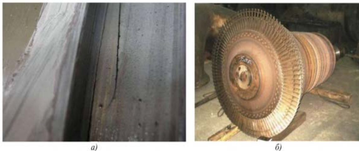
Рис. 2. Виды повреждения роторов турбин а – трещина в расточке; б – разрушение ротора из-за многоциклового усталости
