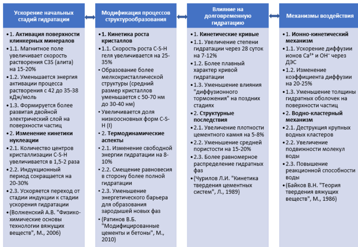
Рис. 4. Процесс влияния магнитного поля на кинетику гидратации цемента.
