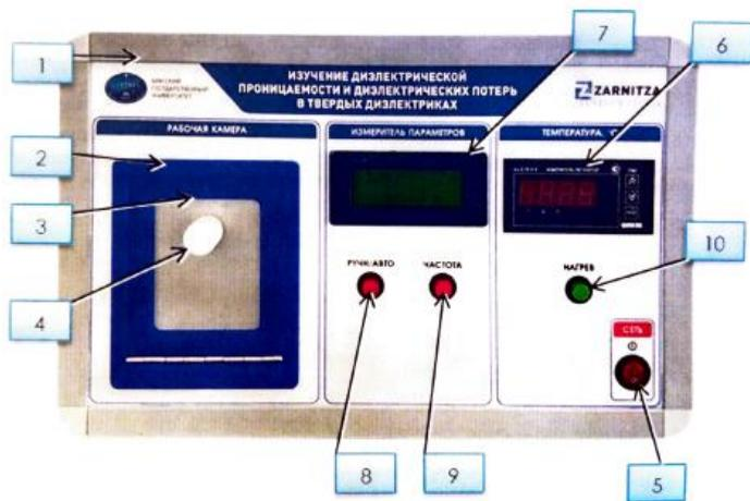
Рис. 4. Состав оборудования: 1 — корпус блока «Изучение диэлектрической проницаемости и диэлектрических потерь», 2 — термокамера, 3 — дверца термокамеры, 4 — ручка дверцы термокамеры, 5 — выключатель электропитания блока «СЕТЬ», 6 — контроллер температуры в термокамере, 7 — дисплей измерителя параметров конденсатора, 8 — кнопка выбора режима измерения параметров конденсатора, 9 — кнопка выбора частоты измерителя параметров конденсатора, 10 — кнопка для включения / отключения нагрева термокамеры
